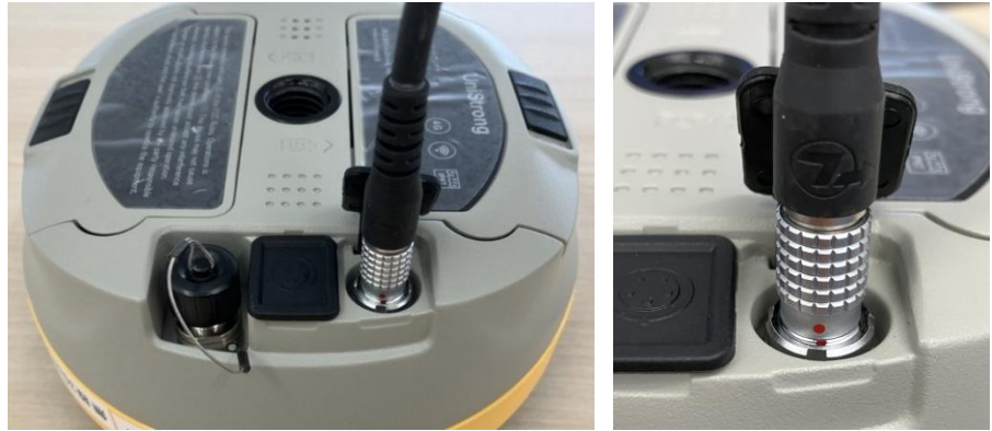
写真 5 受信機への接続
